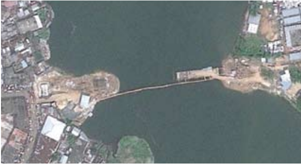
האי המלאכותי שנבנה בצד המערבי של הגשר (מימין) והגשר הקיים המחוזק ממזרח, שתוכננו כפלטפורמה לביצוע הנציבים
